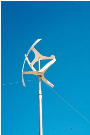
Figur3. Vindkraftverk med vertikal axel. Källa Egen El, fotograf Gunilla Welin
