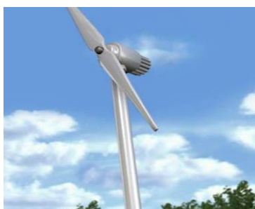
Figur2. Vindkraftverk med horisontell axel. Källa NCC
